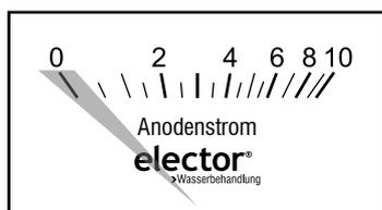
Außerhalb der Heizperiode kann dies vorkommen, wenn das Wasser ausreagiert ist. Innerhalb der Heizperiode wäre die Anode ohne Funktion und muss kontrolliert werden.
